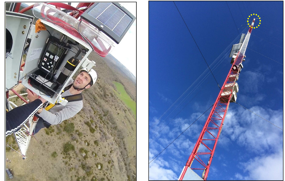
Figure 10 : Modules « BC box » du Batcorder installés sur un mât de mesure (cliché de droite)
